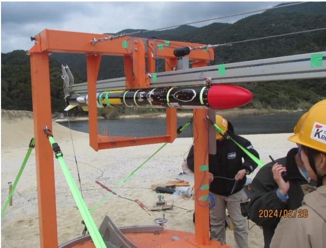
図8 機体のランチャー通し確認作業
