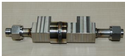
薄肉インジェクターヘッド PN750 への SUS 管溶接, 1/4SUS 管テスト溶接
