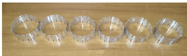
カプラーリング A, C, 内接部品のフレイムボンド処理とガラスコーティング
