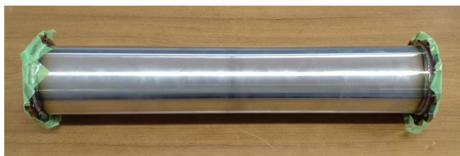
アルミ合金製 LOX リザーバ溶接
