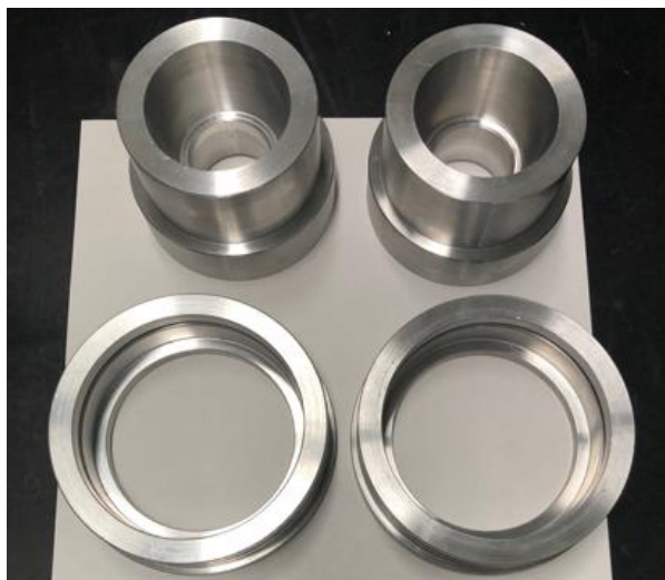
■ソフト99コーポレーション 曲げ試験用カプラーリング嵌合部へのフレイムボンド + H9 ガラスコーティング
