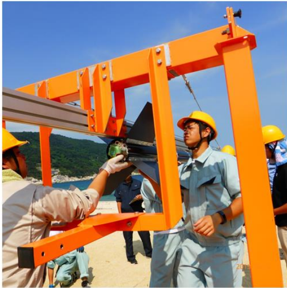
図 8 機体の尾翼とランチャーの干渉
