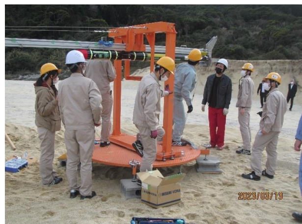
図7 機体のランチャー通し確認作業
