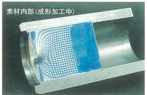
소재내부종단면상으로본 변형의 상태. 변형의 상태를 해당하는 것으로 가공공구의 구조와 형상의 최적화를 도모할 수 있다.
