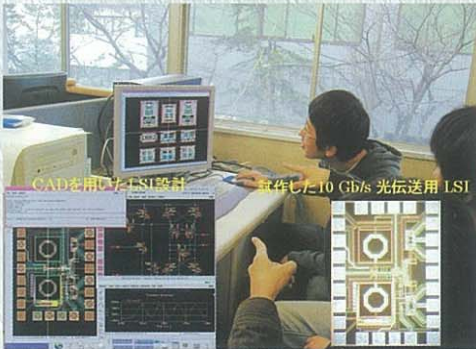
CAD (계산기시뮬레이션)에 의한 광전송용LSI 설계와 시작LSI
