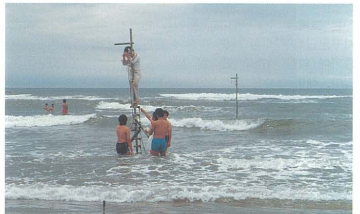
해안에서의 파도관측실습 ...해저지형의 측량을 간조 시에 진행하여 만조 때의 파도와 수중에 표류하는 모래의 양에 대해 조사한다.
