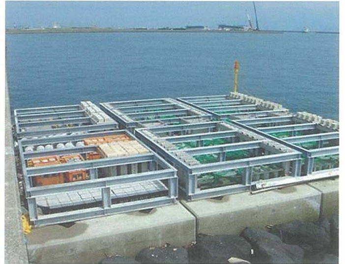
콘크리트의 해양폭로시험 ...각종콘크리트의 해양환경 하(비말대, 갭만대, 해중)에서의 장기내구성을 조사 하고 있다.
