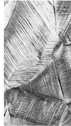
変形した銅多結晶表面のすべり線
